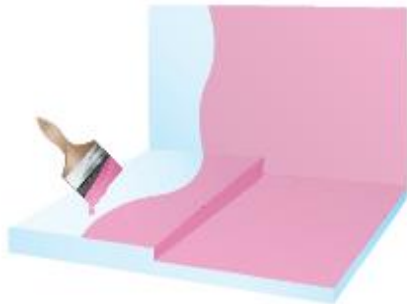
SCHRITT 1 Nasszelle abdichten
